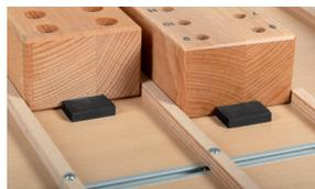
Werkzeugblockanschlag zum Verschrauben
